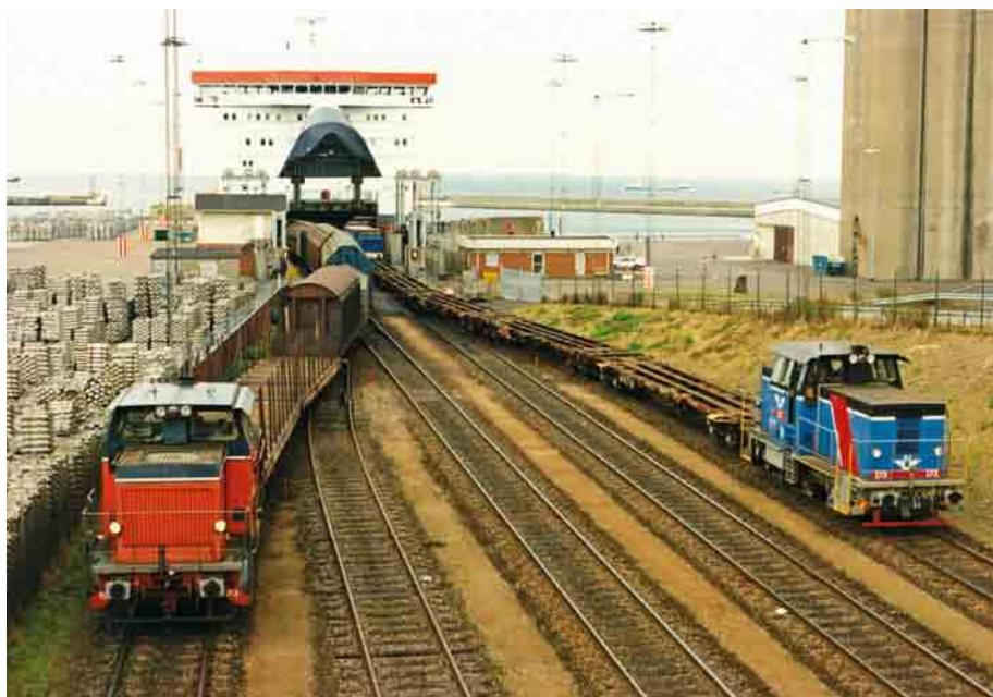
I Helsingborg var der også fem lange opstillingsspor til at placere de vogne, som skulle til og fra færgen. Her rangerer SJ V5 153 og 173 vogne simultant fra M/F Öresund i land den 5. september 1997.
