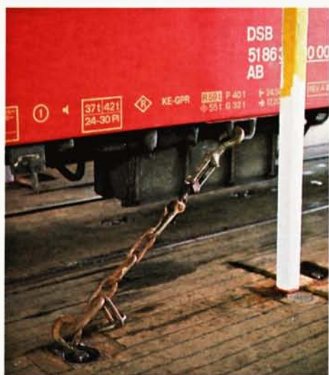
De overtocht per veerboot stelt speciale eisen aan de verankering van een DSB-rijtuig op de Kong Frederik van de dienst Gedser - Warnemünde; 24 oktober 1992. Foto: John Krijgsman.
